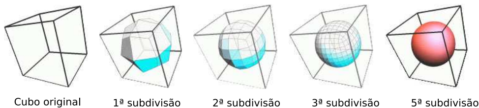
Figura 2.6: Subdivisão de malhas - Algoritmo de Catmull e Clark aplicado em um cubo
