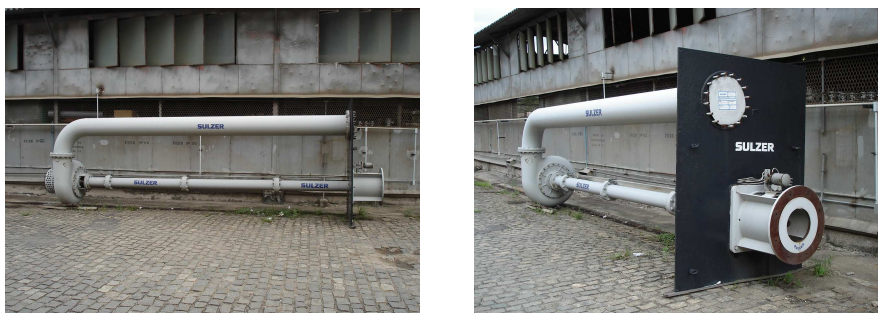
Figura 3.1: Equipamento industrial bomba vertical - fotos tiradas em area de manutenção
