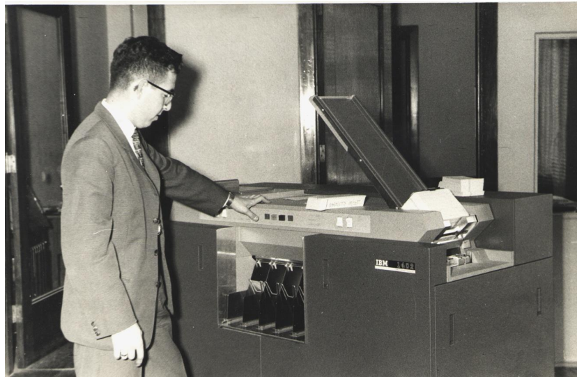
Figura 1. René Cabezas, en la lecto-perforadora 1402 del computador IBM-1401 de la Aduana en Valparaíso.
