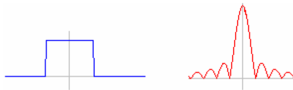
Figura 8 Uma onda quadrada e sua Transformada de Fourier
