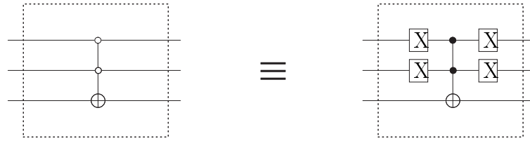
Figura 2.6: Porta Toffoli controlada negativamente, ou seja, por 0's em vez de 1's. Também neste caso, os bits de controle mantêm seus valores originais.
