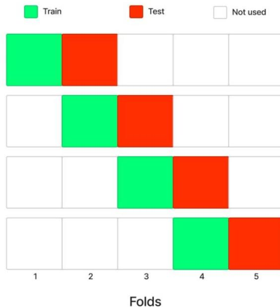
**Figura 3.2** Exemplo de *sliding window* com 5 *folds* em suas 4 iterações.
