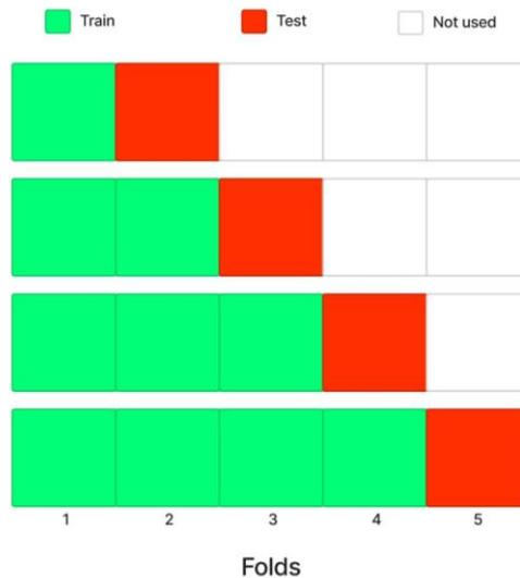
**Figura 3.3** Exemplo de *growing window* com 5 folds em suas 4 iterações.
